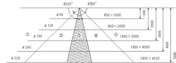
狭角レンズでの感知範囲 (角度:約26×26度) 50cmの距離で約直径30cm円内
